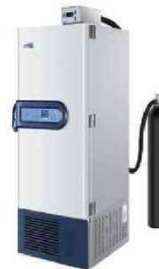
Un sistema de enfriamiento de respaldo LN<sub>2</sub> es un sistema de refrigeración independiente para un congelador ULT. Cuando hay una pérdida de energía o la temperatura del congelador sube al punto de ajuste de alarma alto, el sistema de respaldo LN<sub>2</sub> se puede activar automáticamente para inyectar LN<sub>2</sub> en la cámara para mantener la temperatura del congelador. El sistema de respaldo funciona por la batería recargable cuando hay una pérdida de energía principal.
